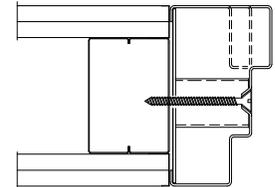
**BUTTED TO EXISTING STEEL STUD & GYPSUM BOARD**
